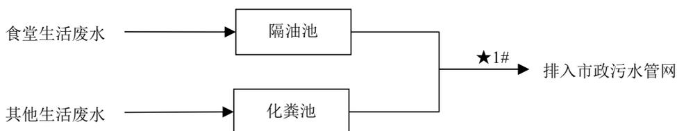
**图 3-1 项目生活废水处理流程（★废水监测点位）**
